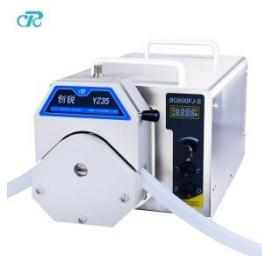
**A bomba peristáltica de alto volume BG600FJ-S / YZ35-13** é uma bomba peristáltica de grande taxa de fluxo da indústria de display digital LED com uma taxa de fluxo máxima de 12000ml / min na velocidade de 600 rpm. Esta bomba de enchimento industrial normalmente é instalada com as cabeças de bomba YZ35 e YZ35-13, YZ35 é a cabeça de bombas de grande fluxo com material de alumínio, YZ35-13 é a cabeça da bomba com material PPS.
